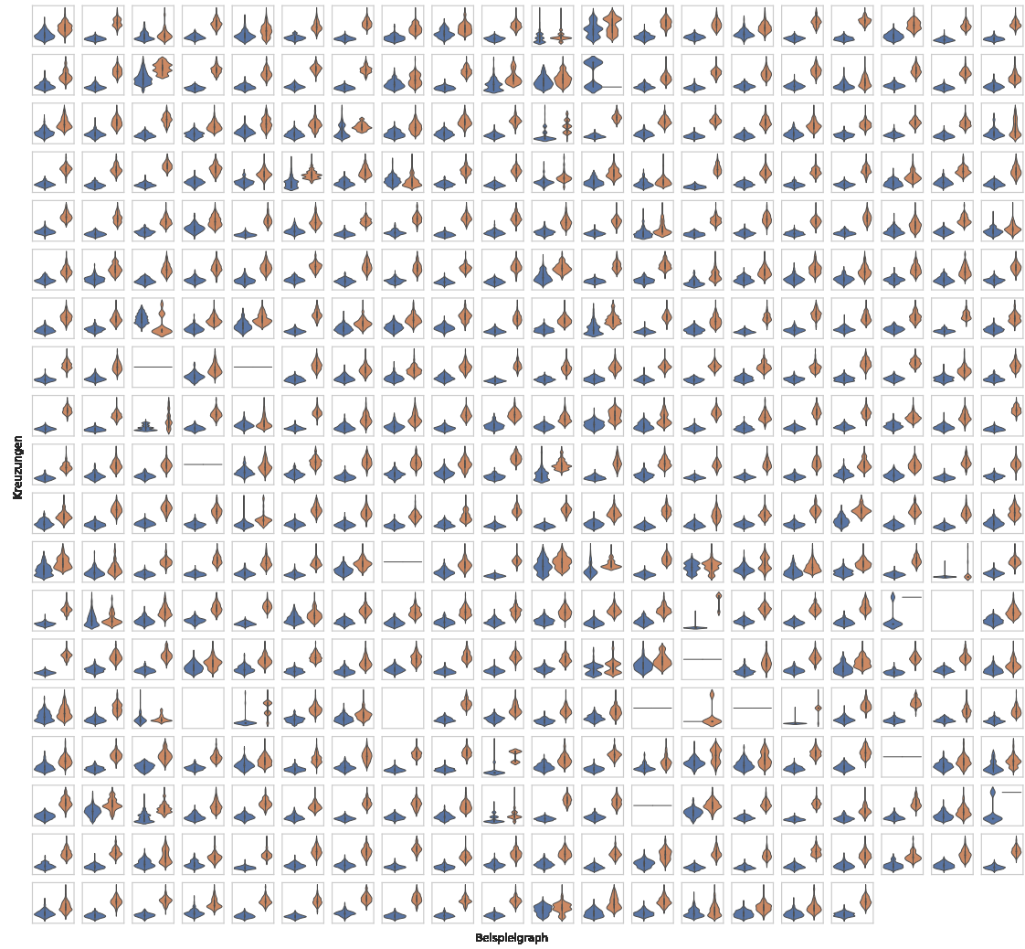
Abb. A.7: Ergebnisse Test 2; Anzahl der Kreuzungen für alle Beispielgraphen in Abhängigkeit der Methode zur Barycenterberechnung; blau Knotenkoordinaten; orange Portkoordinaten
