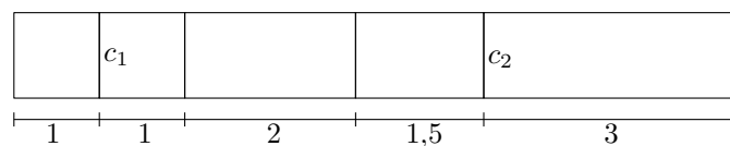
Abb. 4.5: Hier kann ein Schnitt gespart werden, da die Schnittkanten c_1 und c_2 gemeinsam mit Abstand 3 geschnitten werden können. In der ersten Iteration „sieht“ der Algorithmus jedoch keine mehrfach auftretenden Distanzen. Falls nun zunächst die beiden Elemente mit Länge 1 verschmolzen werden, wird die Kante c_1 bereits im Abstand 1 geschnitten. Folglich werden dann keine Schnitte eingespart.
